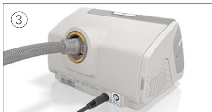
Collegare saldamente il circuito respiratorio all'uscita dell'aria ubicata sul retro del dispositivo.
